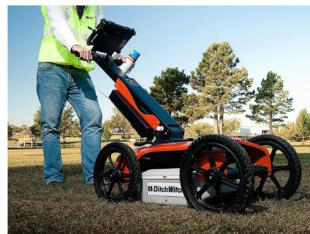
**Géoradar:** appareil géophysique utilisant le principe d'un radar que l'on pointe vers le sol pour en étudier la composition et la structure (Source: Flickr).
